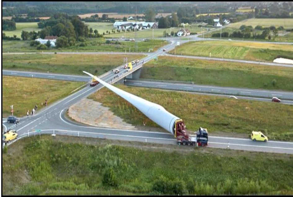
1.22. attēls. Piemērs ar turbīnas lāpstiņas piegādi, veicot pagriezienu (ekrānuzņēmums no https://www.windsystemsmag.com/ )
