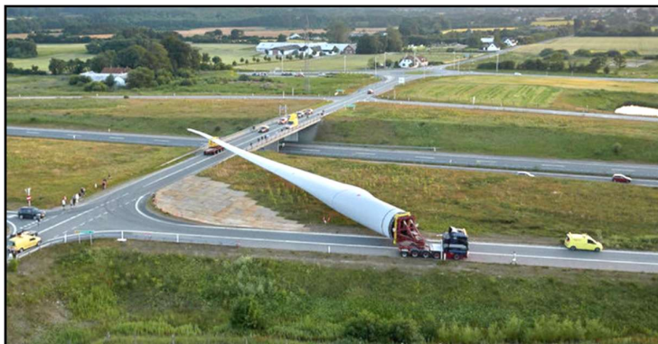
1.18. attēls. Piemērs ar turbīnas lāpstīgas piegādi, veicot pagriezienu (ekrānuzņēmums no https://www.windsystemsmag.com/ )
